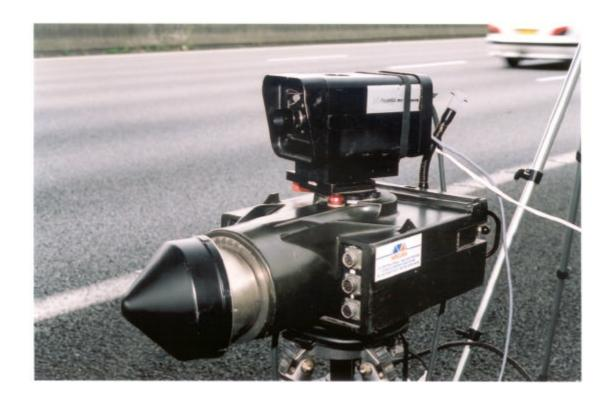
Cinémomètre MULTANOVA type 6F 2 connecté à un dispositif photographique ROBOT type SmartCamera
