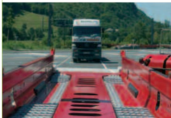
Le wagon Modalohr développé par Lohr est une des pièces maîtresses du ferroutage en France.
