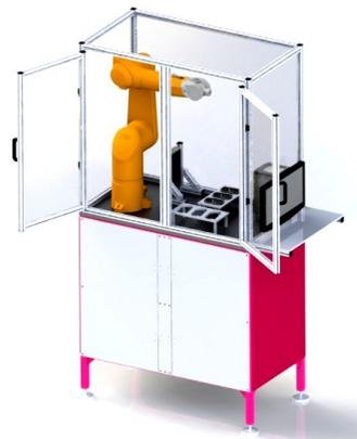
La spécificité de l'approche CRS est de considérer ces trois composants mobiles pour accéder des configurations de prise de vues optimales. (Cf. Fig). Là où la tomographie standard est cloisonnée dans un mode d'acquisition limité, le CRS opère, quant à lui, de manière beaucoup plus agile.
