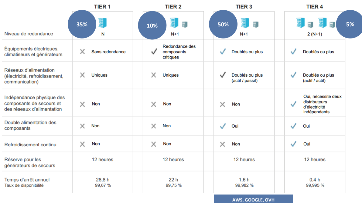
Figure 5 - Répartition des datacenters français par niveau de performance 13
