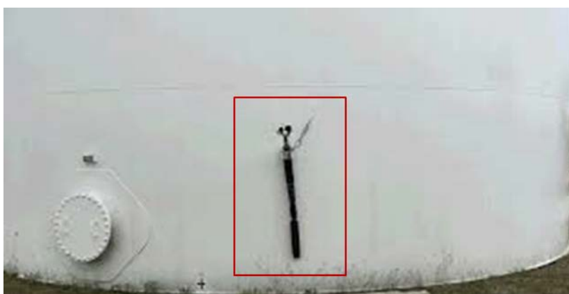
Figure 106 - Robot d'inspection autonome de la société AVITAS système
